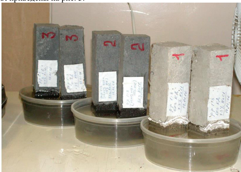
Рис. 1. Высолообразование на поверхности образцов.
